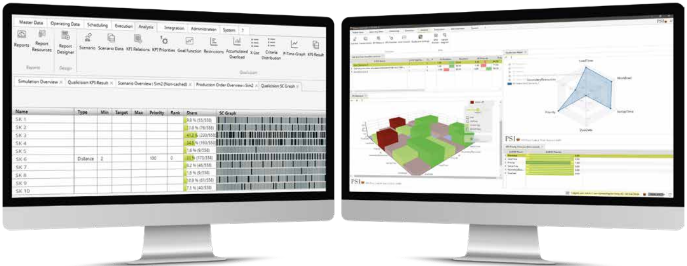
Abbildung 2: Qualicision AI Framework – Sequencing mit Auftragseigenschaftenverteilung und Scheduling mit 3D-KPI-Beziehungsmatrix, KPI-Viewer, KPI-Präferenzeinstellungen.
